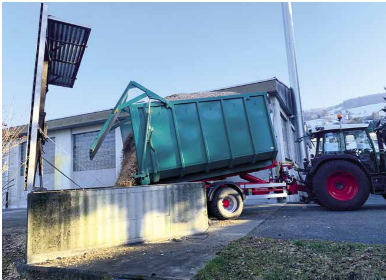
Wärmeverbund Thal: pro Jahr werden rund 3'500 m 3 Schnitzel verbrannt.
